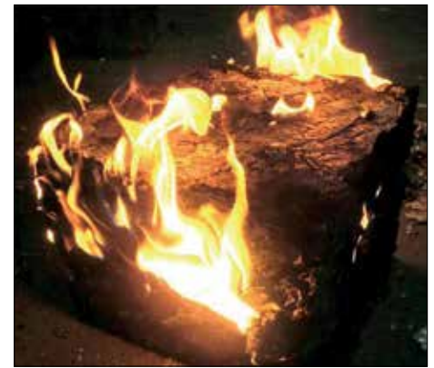
Abb. 4: Die Pyrolyse an der Außenhaut des Schrottpaketes beginnt bei etwa 350 °C (Foto: Jan Steglich)
