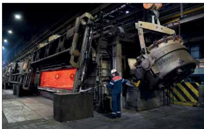
Abb. 6: In der Gießerei wird das Elektrolysemetall mit Schrotten und Legierungsmetallen in 12 gasbeheizten Schmelzöfen chargiert
