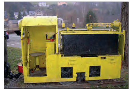
Abb. 5: Lok Metallist zur Streckenförderung (Foto: Uwe Jaschik)
