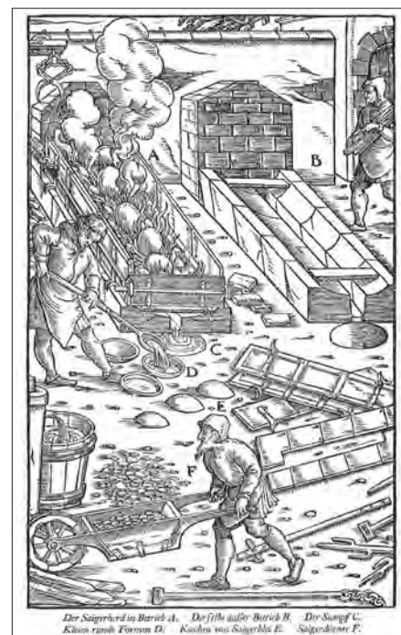
Abb. 10: So sah es aus, wenn im Mittelalter ge-saigert wurde (aus Agricola, Ausgabe 1928, S. 445)
