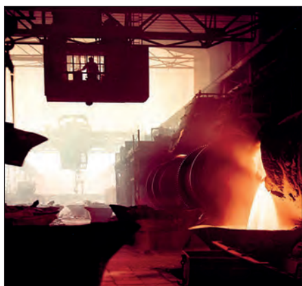
Abb. 11: Schlackenabguss des Konverters 5 auf Bessemerie der Kupfer-Silber-Hütte Hettstedt (Foto Archiv Mansfeld Museum, Hettstedt)
