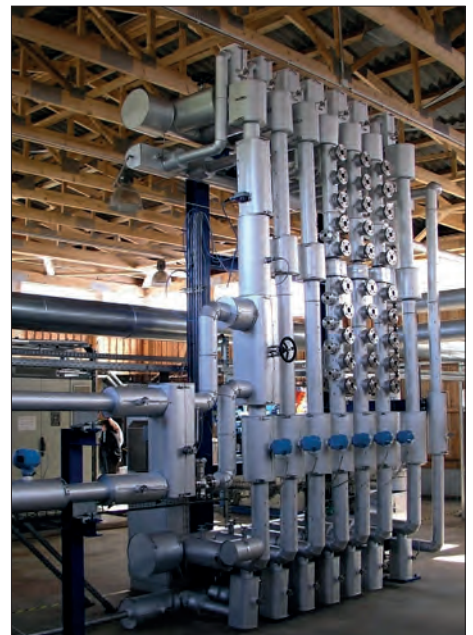
Abb. 5: Vorrichtung zum Testen verschiedener Werkstoffe im hochsalinaren Thermalwasser Norddeutschlands in Groß Schönebeck
