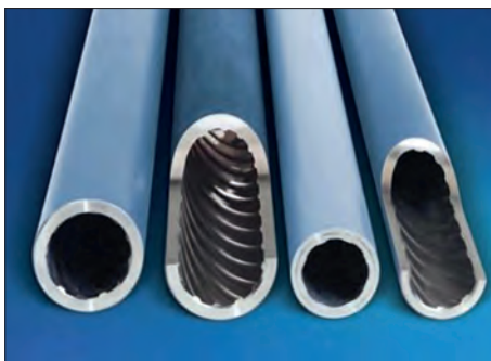
Abb. 9: Nahtlose, kaltgezogene Rohre für Wärmetauscher mit Feldern und Zügen zur Verbesserung der Wärmeübertragung und Verringerung von Ausfällungen
