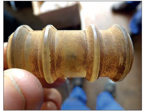
Abb. 11: Molche nach fünfmonatigem Einsatz mit leichten Einsatzspuren: Ablagerung auf der Oberfläche ist unkritisch, Abrieb an den Reinigungs-lippen ist gering
