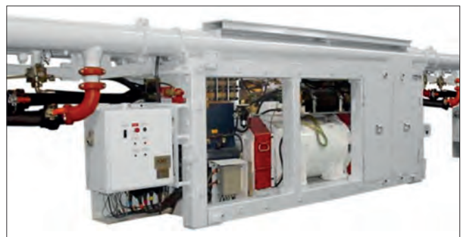
Abb. 1: Weltweit größte Hochdruckstation zur Versorgung des Schildausbaus in der US-amerikanischen Steinkohlengrube Peabody Twentymile, verfahrbar an einer Einschienehängbahn
